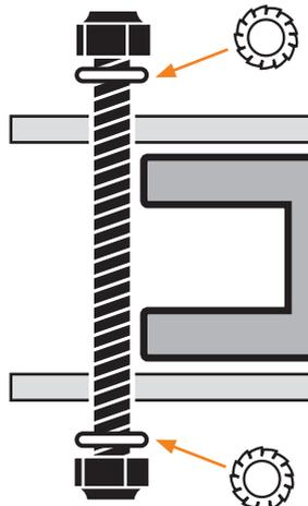
Alle Schrauben nacheinander mit einem Drehmomentschlüssel mit einer Mindestkraft von 40 NM einschrauben.
