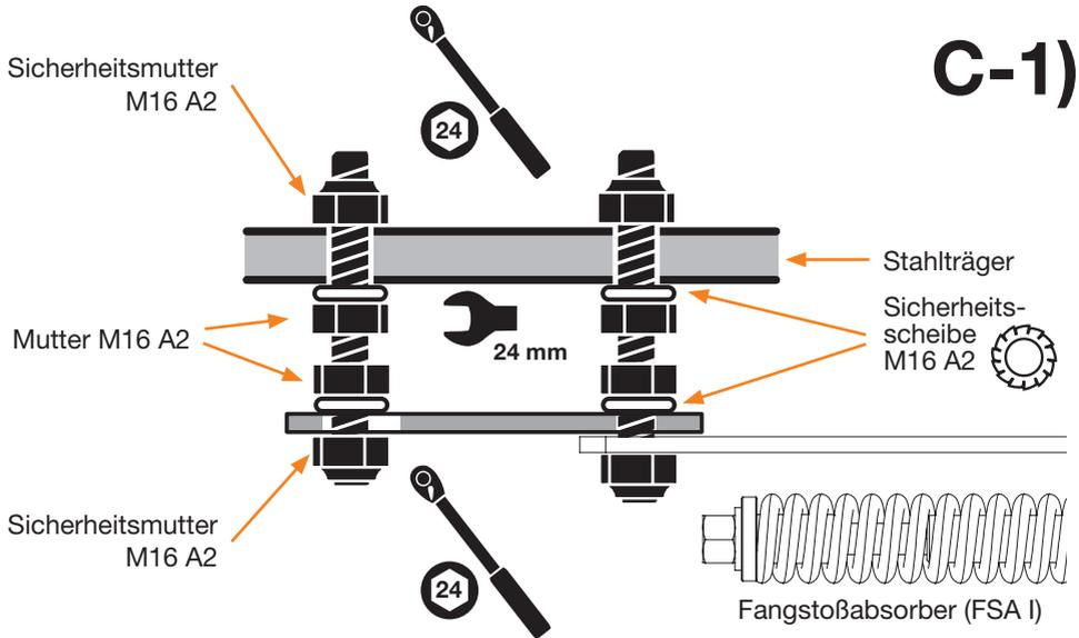
**Befestigung von Grundplatte und Fangstoßabsorber (FSA I) siehe Montageanleitung Wand-system TS WS ES 150-500 Beton / Stahl.**
