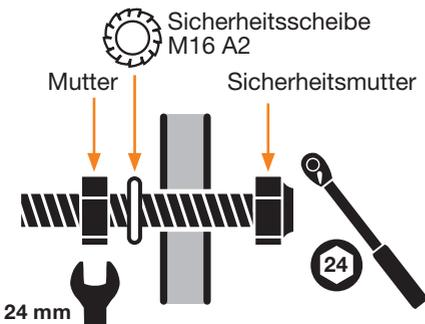
Alle Schrauben nacheinander mit einem Drehmomentschlüssel mit einer Mindestkraft von 40 NM einschrauben.
