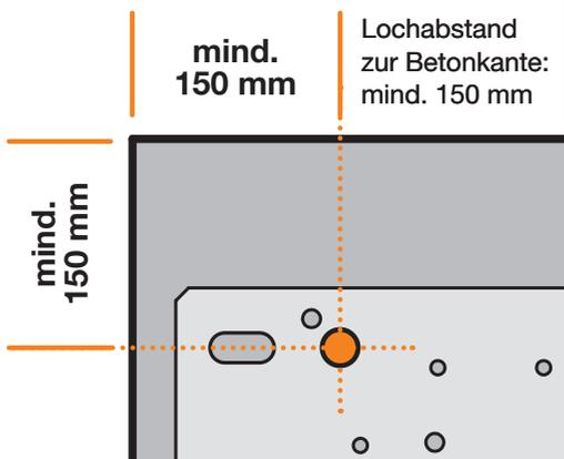
Mit Ø 8 mm Schlagbohrer bis in die Hohlkammer bohren
