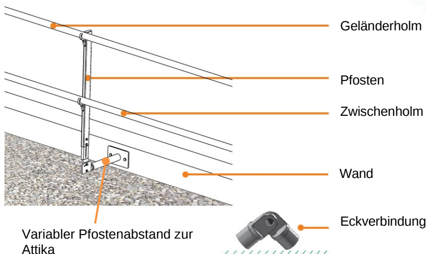
Bild 9: Seitenschutzsystem, Typ: TigaRAIL WAND EASY 200-600
