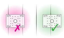
Alle 20 A2 Schrauben müssen nacheinander komplett mit 8 NM eingeschraubt werden, bis der Schraubenkopf am Untergrund satt aufliegt.
