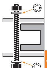
Alle vier Schrauben nacheinander mit einem Drehmomentschlüssel mit einer Mindestkraft von 40 NM einschrauben.
