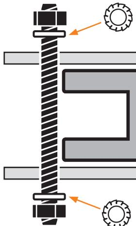
Alle vier Schrauben nacheinander mit einem Drehmomentschlüssel mit einer Mindestkraft von 40 Nm einschrauben.
