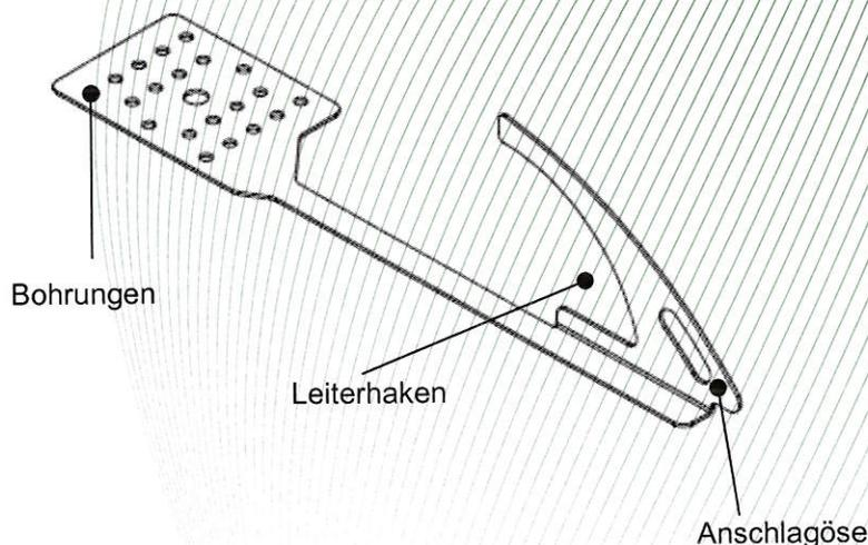
Bild 1: Sicherheitsdachhaken, Typ: DHE verzinkt
