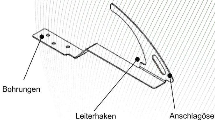
Bild 6: Sicherheitsdachhaken, Typ: DH Plus
