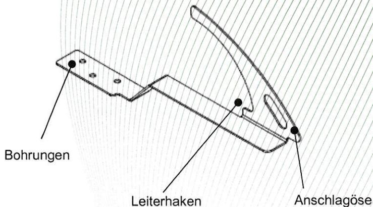
Bild 3: Sicherheitsdachhaken, Typ: DH Plus verzinkt
