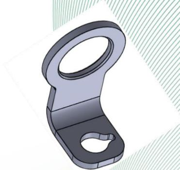
Bild 21: Verankerung, Typ: TS-Lasche (TS-011) (mit Sollbruchstelle und 45° Fase)
