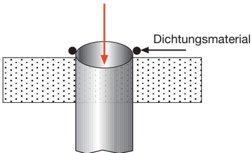
Falls der vorhandene Lüfter in der Dachfläche zu kurz abgeschnitten wurde, verwenden Sie die aufschraubbare Sanierungsmuffe für Flachdach-Sanitärlüfter 100 mm Ø. Schieben Sie die Sanierungsmuffe einfach in den vorhandenen Sanitärlüfter hinein.
