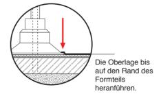
Flansch aus Spezial-Polymerbitumen (talkumiert oder beschiefert). PVC-Formteil ist aus hochwitterungsbeständigem, widerstandsfähigem Spezial-Hart-PVC hergestellt.
