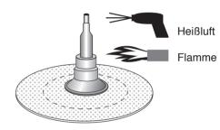
Schrumpfschlauchmanschette von oben nach unten langsam erwärmen.
